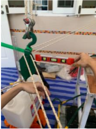
รูปที่ 25 การวัดระดับน้ำของเชือกกระหว่างอะครีลิกและรอก
