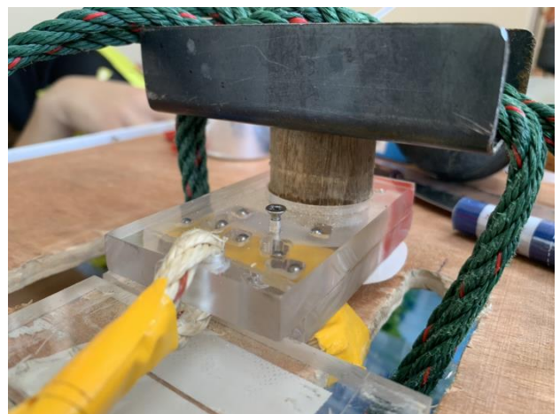
รูปที่ 24 แผ่นอะคริลิก และแป้นถ่วงน้ำหนัก
